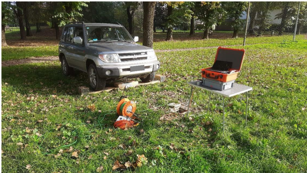
FIG. 3 – REALIZZAZIONE DELLA PROVA SISMICA DOWN-HOLE IN COMUNE DI CAVRIAGO
