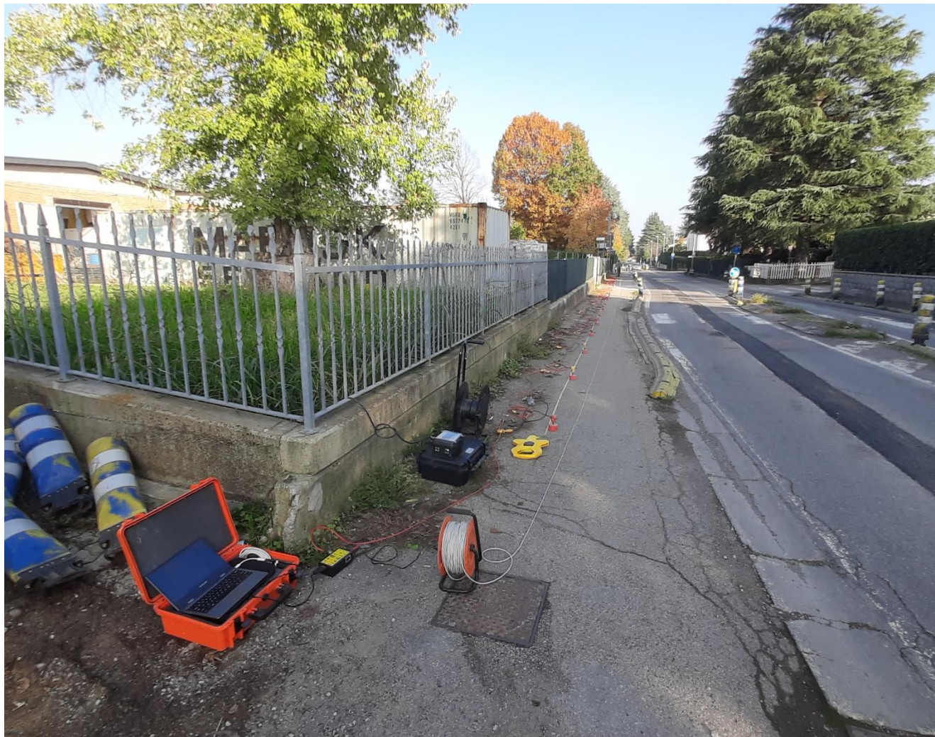
FIG. 5 – FOTOGRAFIA DELLA STRUMENTAZIONE DURANTE L'ACQUISIZIONE DI UNA PROVA HVSR
